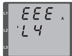
Abb.: Anzeige Messbereichsüberschreitung im Strompfad I4
