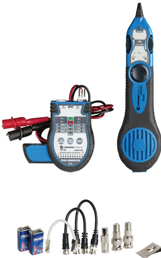
El comprobador de cables multifunción TET-700 se utiliza para probar la continuidad en los cables coaxiales RJ45, BNC y F y en otros cables que no son de conexión. También brinda tonos a través de los conectores RJ45 y BNC así como también los clips de prueba. El TET-700 ofrece potencia de conversación a un teléfono para realizar pruebas. El kit de accesorios TET-6 está incluido con el TET-700. Incluye:
