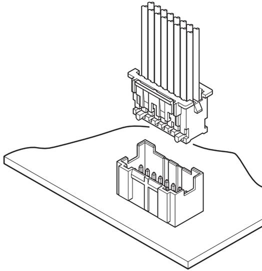
该产品是间距为 2.0mm、压着型、采用双排结构的带锁定电路板对电线连接用连接器。
