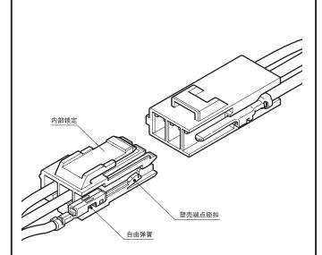
接触部通过采用自由弹簧,降低了接插力并减少了弹簧部 的应力集中,蠕变特性优良、可靠性高。
