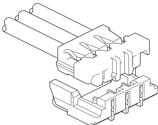
小型低背(高さ1.9mm、奥行き4.3mm)にて、1.3mmピッチ基板対電線用圧着コネクタを実現。
