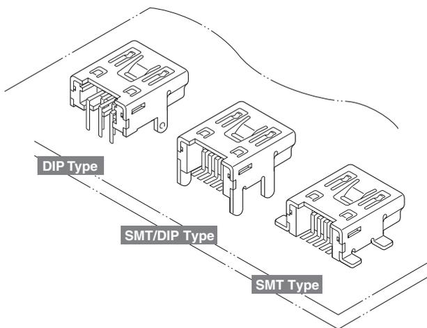
该产品是经过USB2.0认证的插座，最适合于数码相机、MP3等小型、薄型外围设备的外部接口。
