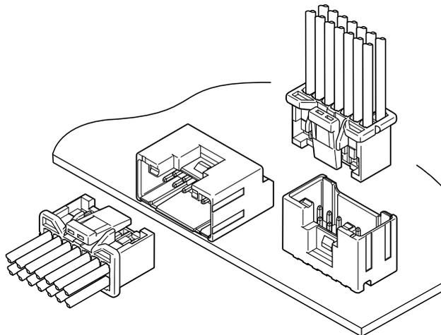
2.0mmピッチ、圧着タイプ、2列構造を採用した強ロック付基板対電線接続用コネクタです。低挿入化を実現しながらも振動やこじり、微小電圧・電流回路に対しても安定した接触状態を発揮します。また、ロック解除時に投影面積内にてロック解除が可能な形状です。
