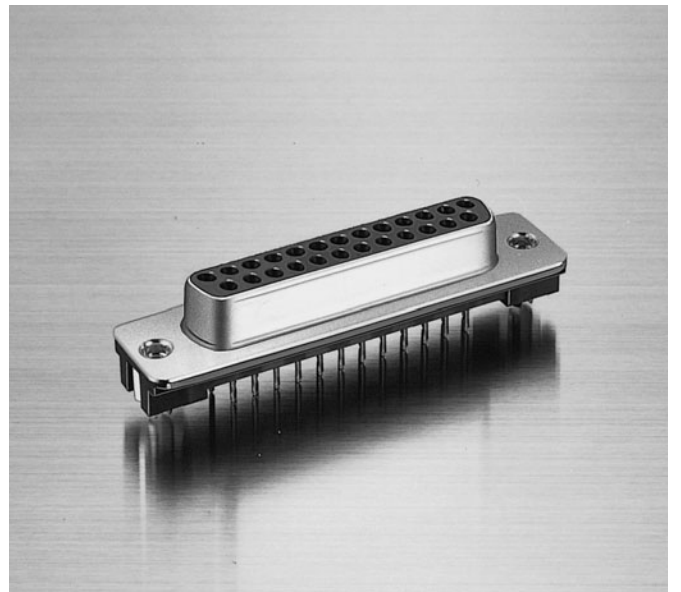
ソケット (ロックねじなし、ロックねじ取付部No.4-40UNCのインチねじのアース金具付)
