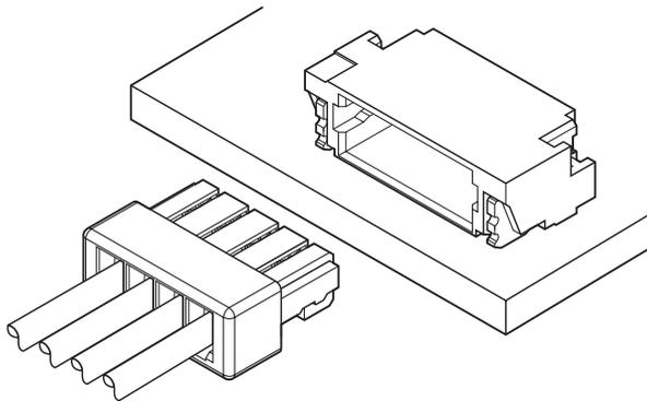
该产品作为间距为 0.8mm 的压接电路板对电线连接用的压着型 SUR 连接器而开发。首次采用电路板对电线用最小级别的 0.8mm 间距的压着方式。采用塑壳锁扣方式，提高了作业性，端子采用集中接点方式，具有高度的接触可靠性。
