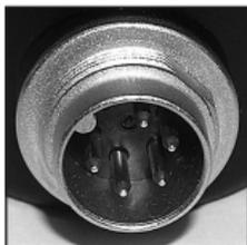
Le connecteur Binder est utilisé pour la communication avec un PC/portable. C'est ici que se branche le câble d'interface (K-107 / K-104B).
