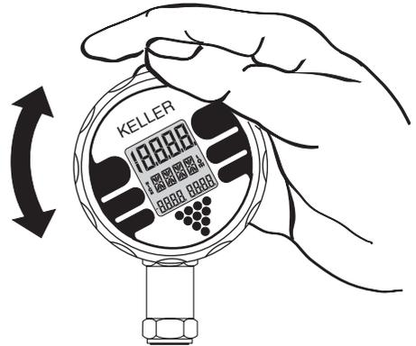
Der Deckel des *Intelligenten Manometers* ist mit einem O-Ring spritzwasserfest abgedichtet. Er lässt sich, sollte die Batterie einmal ausgetauscht werden, leicht von Hand lösen. Lesen Sie dazu den Abschnitt "Batteriewechsel" im Kapitel "Hinweise" auf Seite 12.
