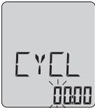
Die erste Ziffer blinkt. Mit *EXE* werden die Ziffern erhöht (1, 2, ... 5).
