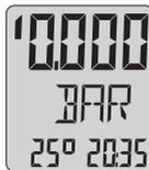
Am *Intelligenten Manometer* können zwei Sensoren angeschlossen werden. Innerhalb von *ZERO* kann durch Aktivieren von *EXE* zwischen diesen beiden Sensoren hin- und hergeschaltet werden. Der Pfeil auf der Anzeige oben links zeigt bei angewähltem Sensor 1 nach oben, bei Sensor 2 nach unten.
