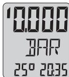
Le *manomètre intelligent* peut être équipé de deux capteurs. En mode *ZERO*, vous pouvez passer d'un capteur à l'autre par la commande *EXE*. La flèche située en haut et à gauche de l'afficheur pointe vers le haut si le capteur 1 est actif, vers le bas si le capteur 2 est actif.
