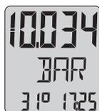
Les 2 afficheurs inférieurs peuvent également indiquer la température ou le temps écoulé depuis la mise en marche (voir "*Mode DISE*", pages 6-7).
