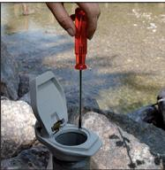
Engagez la sonde avec le câble de sonde à la main dans le tube de mesure de niveau. Le câble de sonde doit pendre librement dans le tube de mesure de niveau, sans vrille, et ne doit pas changer sa position, afin de ne pas fausser les résultats de mesure. Orientez le DCX-22 CTD de telle sorte que le trou de passage du capteur soit traversé par le fluide.
