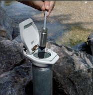
Vissez la bague d'adaptation correspondante sur l'unité de lecture. Une fois montée, la bague d'adaptation repose sur le rebord du cache d'obturation du tube de mesure de niveau. Bloquez l'unité d'enregistrement dans la bague d'adaptation à l'aide du circlips fourni.
