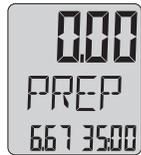
Die Testzeit ist jetzt programmiert (35:00). Der Start des Leak-Test ist auf der nächsten Seite beschrieben.
