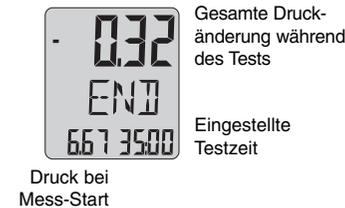
Nach Ablauf des Testvorgangs werden die gemessenen Werte "eingefroren". Die Rückkehr zum PREP-Modus aus der END-Anzeige erfolgt durch Aktivieren von PREP.
