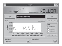
Die Übertragung von Daten beginnt immer bei der zuletzt aufgenommenen Speicherung und kann bis zum vollständigen Auslesen des Speichers ausgedehnt werden. Der Speicher kann beliebig oft ausgelesen werden.
