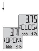
Druckschalter öffnet. Zustand und Schaltdruck werden angezeigt.
