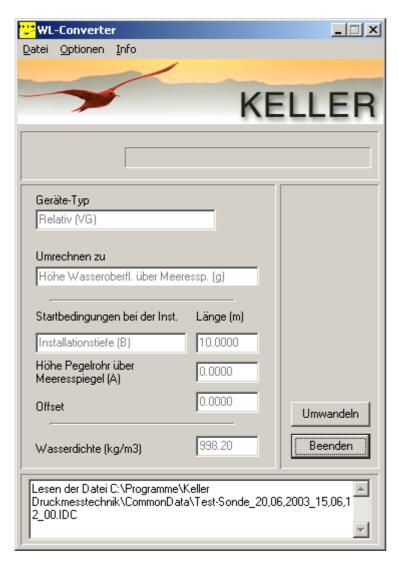
Nach dem Drücken von **Umwandeln** werden alle Messwerte in Wasserstandswerte gewandelt. Die Einheit der gewandelten Werte ist immer Meter (m).
