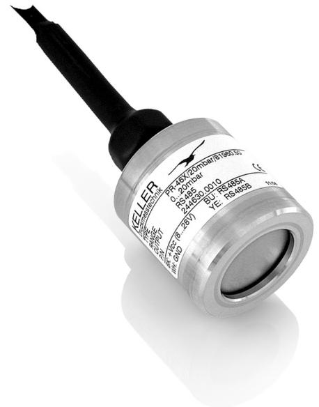
Dieser Drucktransmitter ist auch als eigensichere Version (Serie 46 X Ei) lieferbar. Sie wird in explosionsgefährdeten Bereichen eingesetzt, die Betriebsmittel der Kategorie 1 und 2 erfordern und darf nur in Verbindung mit nachgewiesener eigensicherer Ausrüstung verwendet werden!
