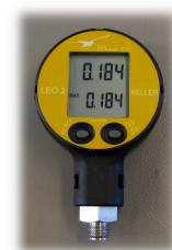
Anzeige Druck von bar umgerechnet in kundenspezifische Einheit
