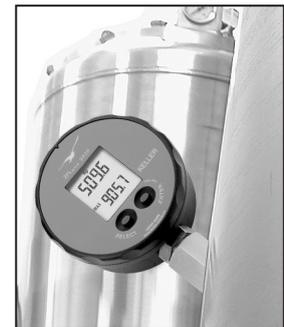
Für die Austarierung eines Tankes kann das Gewicht von jeder einzelnen Kraft-Messzelle abgerufen werden. Ist das Tank-Fassungsvermögen bekannt, kann die Kalibrierung der Tankinhaltsanzeige auch vor Ort erfolgen, indem beim Anzeigegerät die beiden Punkte "leerer Tank" und "voller Tank" vor bzw. nach dem Füllen über die Eingabetasten gesetzt werden.
