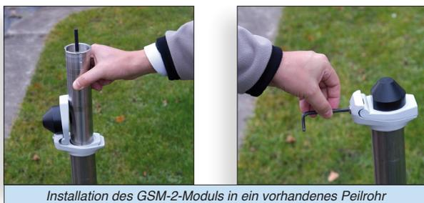
Installation des GSM-2-Moduls in ein vorhandenes Peilrohr
