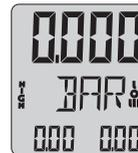
Der neue Nullpunkt ist gesetzt und dauerhaft gespeichert. Nach dem Ausschalten des Gerätes bleibt dieser Nullpunkt also erhalten.
