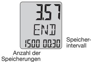
Die Anzeige END signalisiert das Ende des Speichervorgangs. Die Rückkehr zum PREP-Modus aus der END-Anzeige erfolgt durch Aktivieren von PREP.
