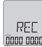
Erste Ziffer blinkt; mit EXE Ziffer erhöhen. Mit STEP zur nächsten Ziffer.
