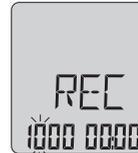
Zweite Ziffer blinkt; mit EXE Ziffer erhöhen. Mit STEP zur nächsten Ziffer, etc.
