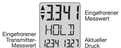
⚠ Wird im Überlastbereich des 10 bar Kalibrators bei erhöhter Auflösung als eine "1" gelesen, folglich 13.341 bar
