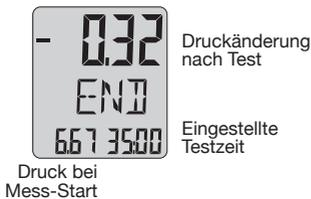
Nach Ablauf des Testvorgangs werden die gemessenen Werte eingefroren. Die Rückkehr zum PREP-Modus aus der END-Anzeige erfolgt durch Aktivieren von PREP.
