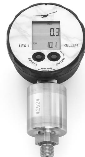
LEX 1 avec capteur de pression capacitif
