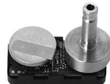
dV-1 OEM-Modul mit eingelöteter Batterie und Drucksensor-Anschluss-Nippel ø 5 mm
