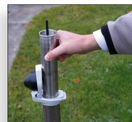
Après mise en place, le module GSM 2 émet sa configuration, avec l'identification et la position du point de mesure, vers le système de gestion de données qui enregistre et gère alors immédiatement et automatiquement le nouveau point de mesure ainsi équipé.
