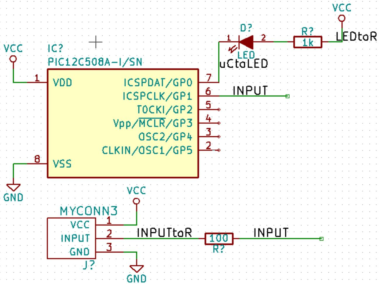
40. Intéressons-nous maintenant aux broches non connectées. Les broches ou fils qui ne sont pas connectés génèrent une mise en garde lors de la vérification par KiCad. Pour éviter ces messages de mise en garde, vous pouvez préciser que le choix de ne pas connecter les fils est délibéré ou bien indiquer manuellement chaque absence de connexion.
