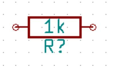
12. Pour placer une autre résistance, cliquez à l'endroit où vous souhaitez la voir apparaître. La fenêtre *Sélection Composant* apparaîtra à nouveau.
