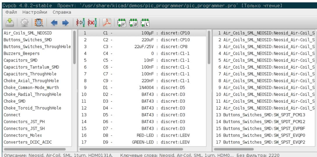
Фильтрация согласно списку фильтров, указанных в свойствах выбранного компонента схемы. Имеющиеся фильтры компонента схемы перечисляются в центральной части строки состояния, внизу главного окна.
