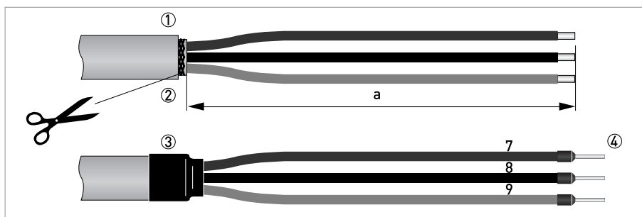
4-9. ábra: A C gerjesztőáram-kábel előkészítése a jelátalakítóhoz
