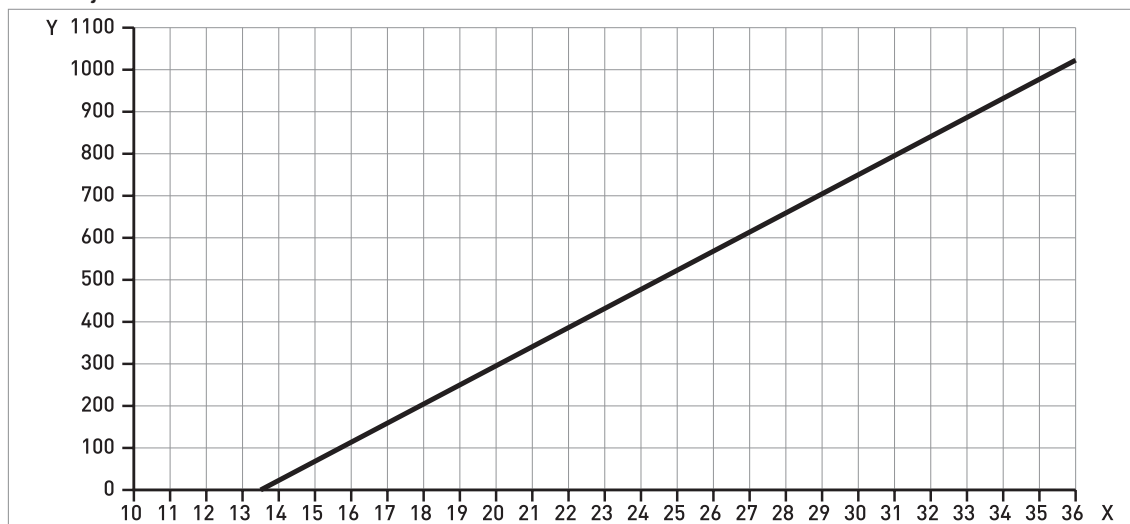
Obrázek 8-3: Minimální napájecí napětí na svorkách výstupu pro proudový výstup 22 mA (přístroje se schválením Ex d / XP/NI)
