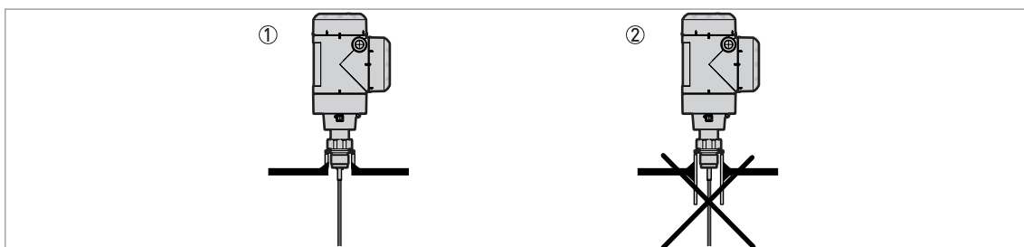
Obrázek 3-4: Návrky pro závitové provozní připojení
