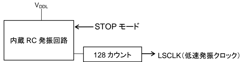
図 6-3 低速内蔵 RC 発振モードの回路構成
