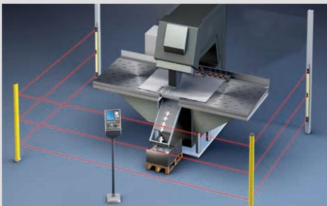
MLD 500 com indicador luminoso de muting integrado em uma aplicação AS-i Safety com muting sequencial.
