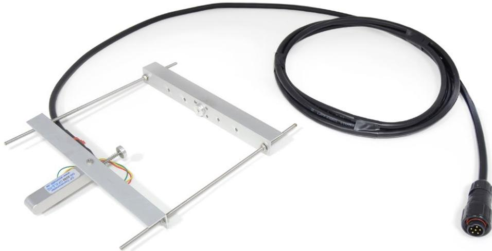
*Figure : Dendrometer probe*
