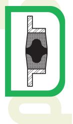
Joint compact pour des applications hydrauliques lourdes, pour des logements composés de plusieurs parties. La partie centrale du joint est un élément en gomme sur lequel sont vulcanisées deux bases en section "U" en toile et gomme. Il a deux bagues de guidage en forme de "L" ce qui empêche l'extrusion du joint et le contact métal-métal entre le piston et la chemise du vérin. Il forme un ensemble qui a une grande résistance à l'usure, à l'extrusion et aux montées de pression.
