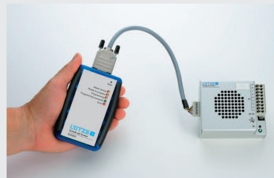
Mit dem Programmer wird innerhalb von wenigen Sekunden das Mem-File auf den Audiosignalgeber gespielt.
