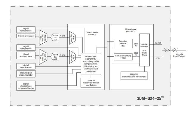
Figure 15 - 3DM-GX4-25<sup>™</sup> Block Diagram
