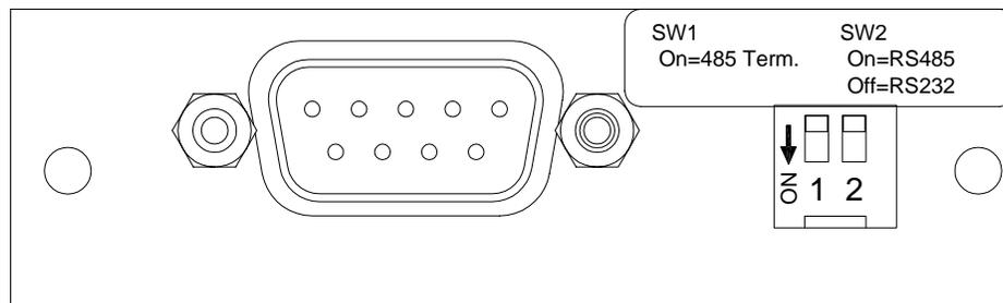
**Figure 2-10 RS232/RS485 Modbus**
