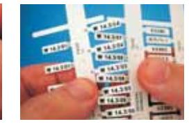
La carte imprimée est divisée en arêtes en pliant et en rompant les extrémités de jonction.
