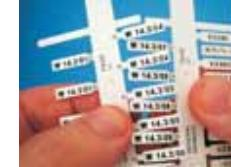
La tarjeta impresa se divide en aletas plegando y partiendo los extremos de unión.
