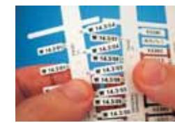
Die gedruckte Karte wird in Äste unterteilt, indem die Verbindungsstücke gebogen und anschließend abgebrochen werden.
