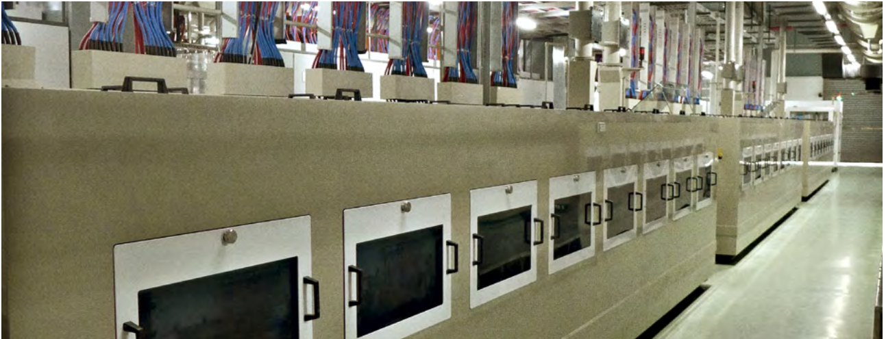
Una línea de metalización horizontal utilizada para rellenar de cobre las microvías del producto HDI.
