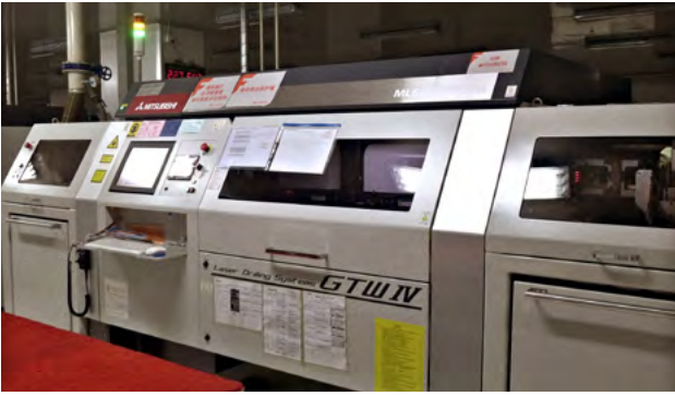
La máquina de taladrado láser se utiliza en la producción de HDI.
