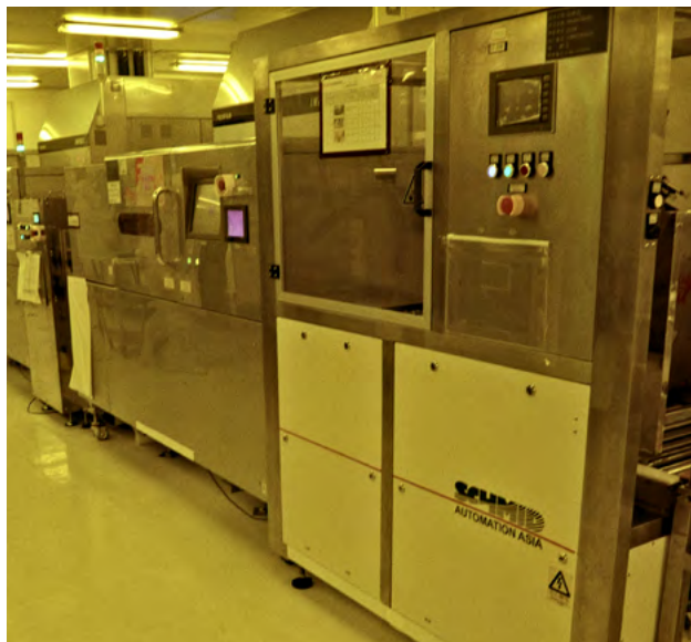
Una máquina de Insolación Directa por Láser (LDI) transfiere e imprime el patrón directamente en el material de la tarjeta de circuito impreso por medio de haces de láser.
