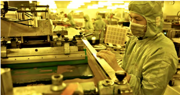
Laminointiasema puhdistilassa, Suntak, Shajing. UL pitää internetissä avointa tietokantaa, jossa kuka tahansa voi hakea hyväksytyjä piirilevyjä, laminaatteja ja pintakäsittelymateriaaleja.
