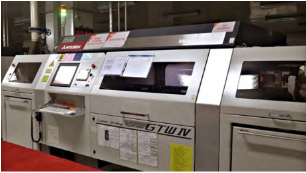
Die Laserbohrmaschine kommt in der HDI-Fertigung zum Einsatz.
