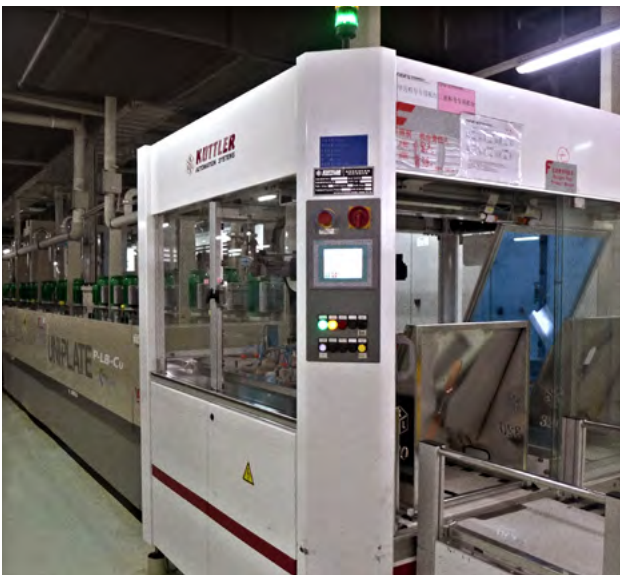
Horizontale Bohrlochreinigungs- und Durchkontaktierungs-Anlage.
