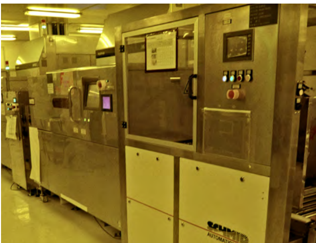
Ein Laser Direct Imaging-System (LDI) überträgt und druckt das Muster mithilfe von Laserstrahlen direkt auf das Leiterplattenmaterial.
