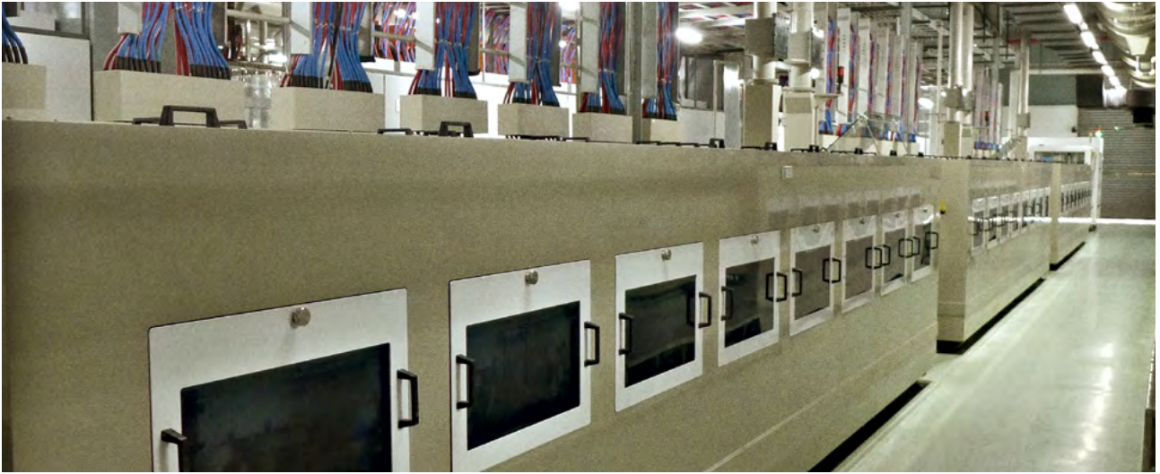
Vaakasuntainen kuparointilinja HDI-tuotteen mikroläpivientien kuparittamiseen.
