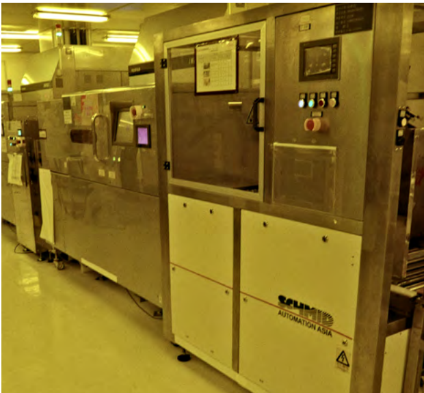
Laser Direct Imaging (LDI) -kone tulostaa kuvion suoraan piirilevymateriaalille lasersäteen avulla.
