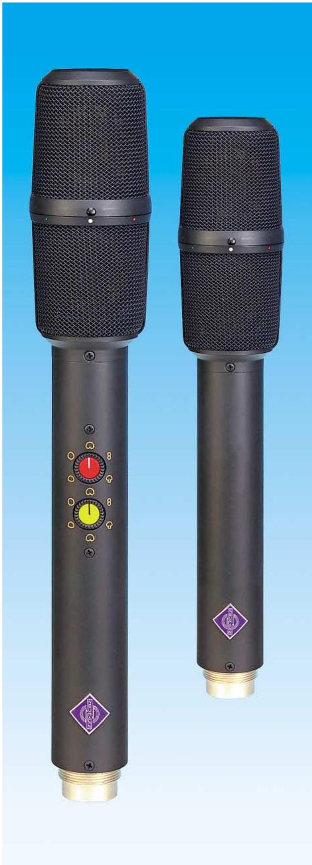
**D**ie Stereo-Mikrophone SM 69 fet und USM 69 i besitzen jeweils zwei getrennte Doppelmembran-Kapseln, die übereinander angeordnet sind und sich gegeneinander verdrehen lassen. Die Richtcharakteristiken der beiden voneinander unabhängigen Kapseln können reproduzierbar umgeschaltet werden.
