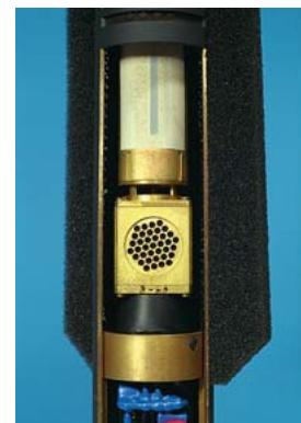
Das Mittensystem vereinigt die hohe Dämpfung für seitliche Schallanteile (ähnlich der der Hyperniere, ca. 10 dB) mit dem großen Vor-/Rückverhältnis der Superniere, indem es von hinten einfallenden Schall ebenfalls um ca. 10 dB dämpft. Darüber hinaus macht dieses Prinzip das Mikrophon unempfindlicher gegen Wind- und Popstörungen als normale Richtmikrophone.
