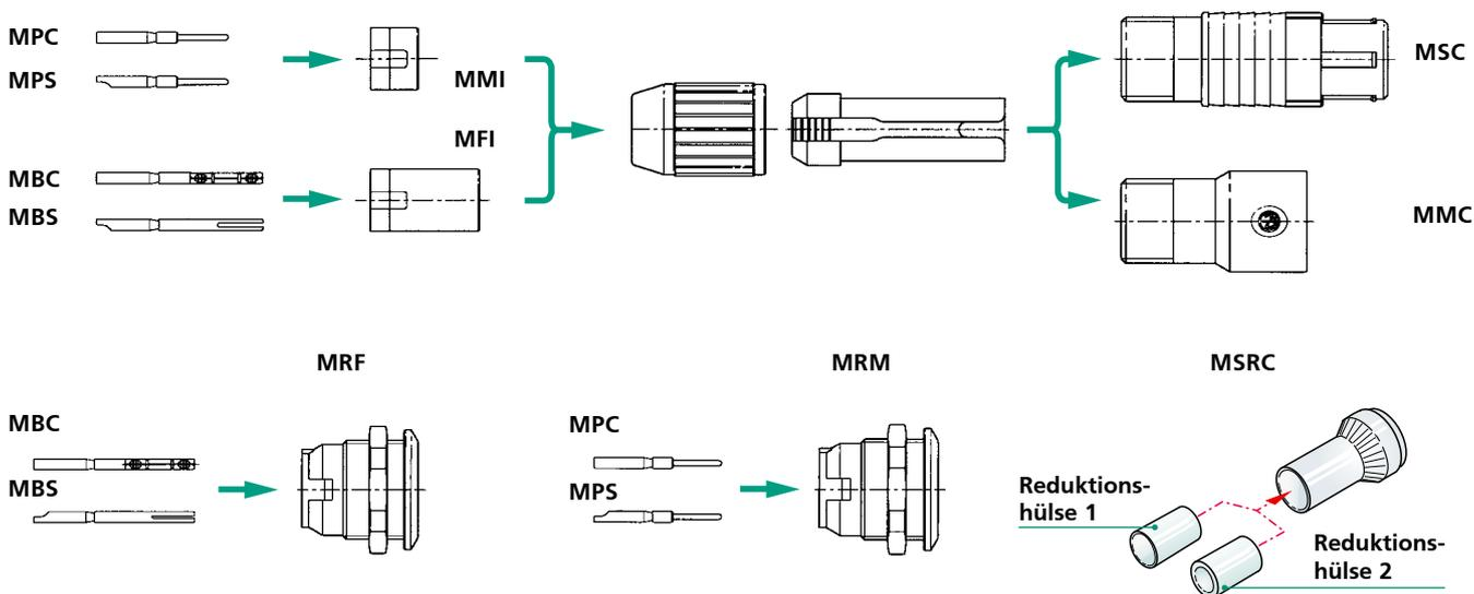
Gehäuse und Einsatz montiert, Kontakte müssen separat bestellt werden.
