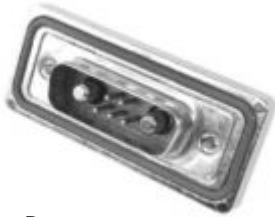
Contact arrangement 7W2, pin connector loaded with straight power contacts in waterproofed version (IP67) for rear mounting. Polbild 7W2, Stiftsteckverbinder bestückt mit geraden Hochstromkontakten in wasserdichter Ausführung (IP67) für rückseitige Montage.
