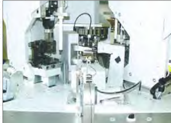
The fully automatic crimp machine customizes up to 1.200 wires per hour. Die vollautomatische Crimpmaschine konfektioniert bis zu 1.200 Leitungen pro Stunde.
