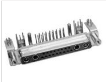
Fig. 1: Mixed Layout socket connector, contact arrangement 21WA4, 2 high power and coaxial contacts with right angled PCB termination and several accessories Abb. 1: Mixed Layout Buchsensteckverbinder, Polbild 21WA4, 2 Hochstrom- und Koaxialkontakte mit abgewinkelter Leiterplattenanschluss und verschiedenen Anbauteilen
