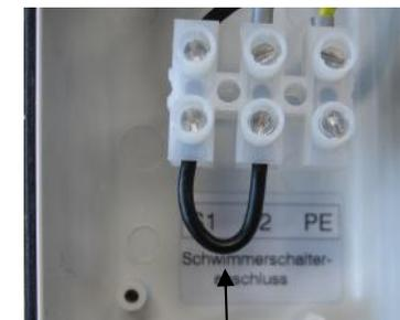
Zum Anschluss eines Schwimmerschalters bzw. externen Schalters, muss die Brücke entfernt werden.
