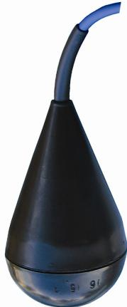
Il regolatore di livello MS1 electronic Ex con un circuito elettrico a sicurezza intrinseca certificato può essere impiegato per il monitoraggio e/o la regolazione del livello di liquido in ambienti a rischio di esplosione delle zone 0, 1 e 2 come pure dei gruppi di gas IIA, IIB e IIC, che sono a rischio di esplosione a causa di sostanze infiammabili nel campo delle classi di temperatura da T1 a T6.
