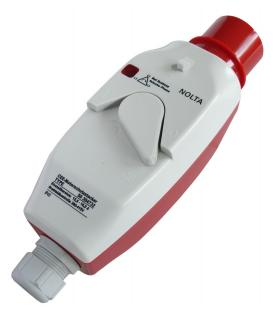
Motorschutzstecker mit integriertem Motorschutzschalter mit temperaturkompensierter thermisch/magnetischer Auslösung. CEE-Stecker 16 A und 32 A, wahlweise mit und ohne Drehfeldkontrolle und Phasenwender
