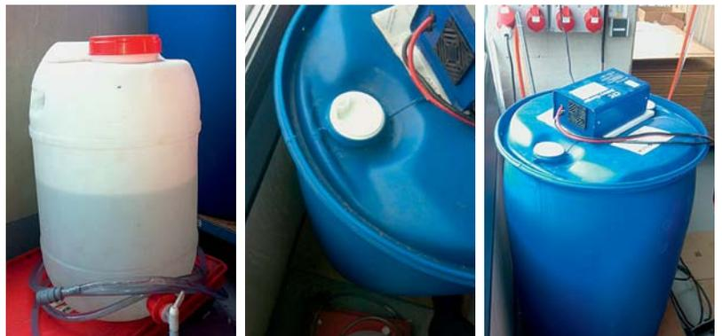
Der NIVA M3 Niveauregler ist ein Schwimmerschalter, der speziell für den Einsatz in Verbindung mit Faßpumpen entwickelt wurde. Mit einem maximalen Durchmesser von nur 44 mm passt er problemlos durch die gängigsten Spundlöcher.
