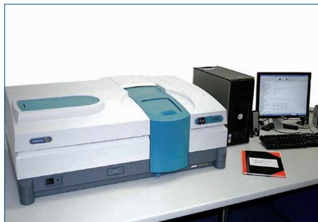
Spectrophotomètre de pointe dans les laboratoires de calibration optek
